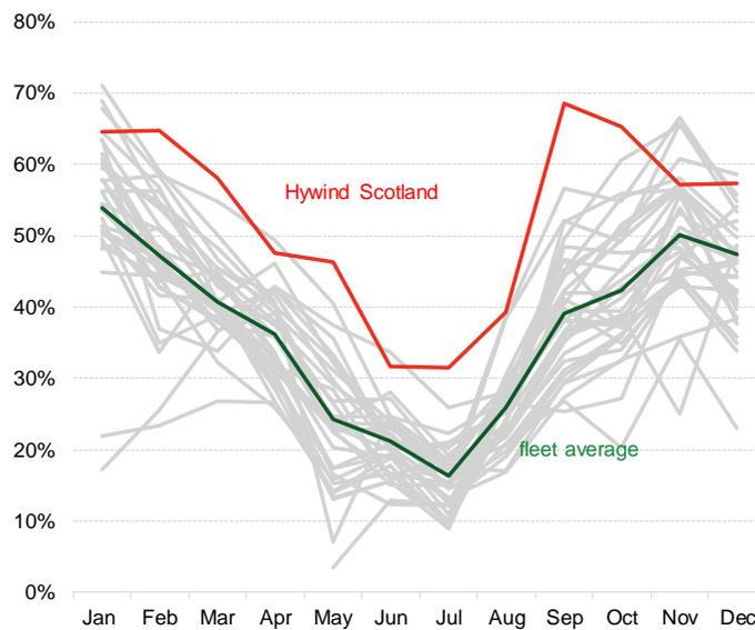
Figura 9: Factor de capacidad de la eólica marina flotante comparado con los proyectos de cimentación fija (Fuente: BloombergNEF, 2018).
