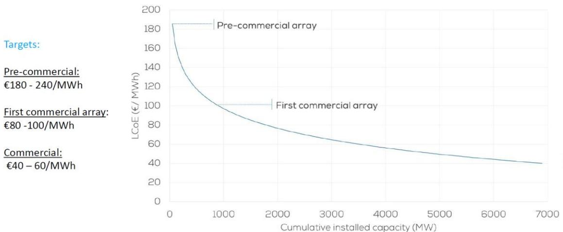
Figura 17: Reducción de costes (LCOE) de la eólica flotante en función de la potencia instalada acumulada (Fuente: Windeurope 2019).
