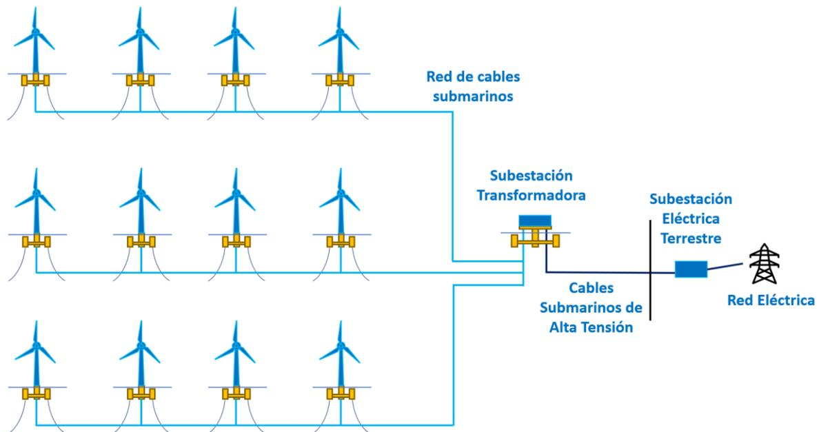
Figura 13: Conexión de un parque eólico a la red eléctrica (Fuente AEE).
